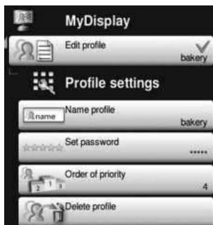
Измените имя профиля (например, на «Пекарня»), установите пароль и присвойте уровень приоритета. Приоритетность определяет иерархическое положение профиля относительно других профилей на данном аппарате.
