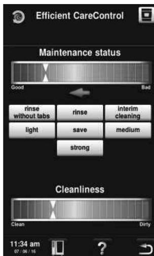
**Efficient CareControl** определяет время выполнения очистки. При этом система Efficient CareControl учитывает индивидуальный режим очистки, а также степень использования аппарата, например, длительные простои или завершение работы.
