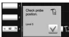
Если термозонд вставлен неправильно или соскальзывает при поэтапной загрузке, появляется следующее предупреждение.
