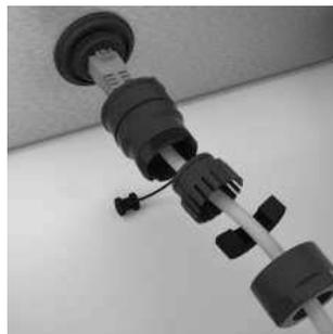
Следует нанизать все компоненты на кабель, как показано на рисунке. Затем вставьте сетевой кабель в разъем.
