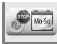
Нажмите кнопку **Режим работы графика очистки** и с помощью поворотного регулятора выберите режим – появление предупреждения или выполнение принудительной очистки в определенные дни недели.
