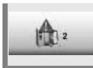
Нажать кнопку **2. Предупреждение при загрузке: Проверить продукт** и с помощью поворотного регулятора установить или отключить время до предупреждения (5–180 с; выкл.).
