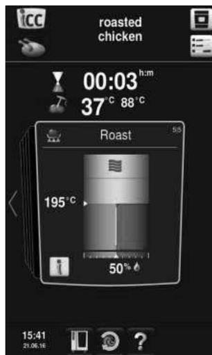
Жарка в режиме сочетания пара и горячего воздуха (влажность 50% при температуре в рабочей камере 202°C).
