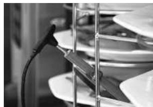
При обработке тележки-кассеты для тарелок в режиме **Finishing®** вставляйте термозонд в керамическую трубку на тележке-кассете.
