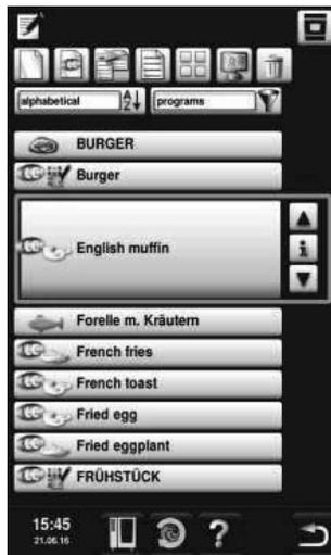
При нажатии кнопки «Режим программирования» аппарат переходит в **режим программирования**. Описание см. в разделе «Режим программирования».
