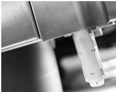
USB-интерфейс предназначен исключительно для импорта и экспорта данных, а также обновления программного обеспечения с помощью USB-накопителя. Поэтому он не должен использоваться для зарядки или эксплуатации других электронных устройств, например мобильных телефонов.
