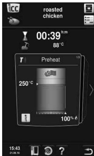
После нажатия кнопки «iCC Cockpit» или автоматически через 10 секунд аппарат переключится на iCC Cockpit. Аппарат прогревается автоматически.
