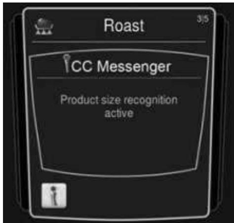
iCC Messenger информирует о процессах и корректировках, выполняемых в данный момент системой iCookingControl. Через 6 секунды iCC Messenger автоматически скрывается с экрана.
