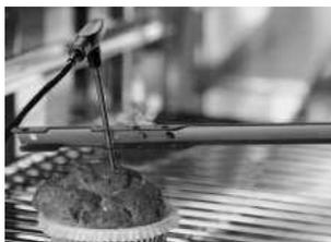
Если существует вероятность, что термозонд может самостоятельно выпасть из продукта, используйте вспомогательное позиционирующее устройство (например, при обработке продуктов с мягкой консистенцией или тонких продуктов).
