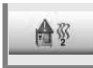
Нажать кнопку **2. Предупреждение при приготовлении: Проверить продукт** и с помощью поворотного регулятора установить или отключить время до предупреждения (5–180 с; выкл.).
