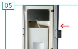
Закрывать крышку БЛОКА ОХЛАЖДЕНИЯ.
