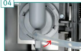
РЫЧАГ РАЗБЛОКИРОВАНИЯ КАМЕРЫ СМЕШИВАНИЯ повернуть против часовой стрелки. Снять КАМЕРУ СМЕШИВАНИЯ.
