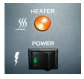
Шаг 3- ий: поверните контроллер температуры до отметки 10. Рекомендуется дать 30 минут для разогрева, перед продолжением.
