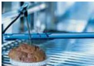
Если существует вероятность, что термозонд может самостоятельно выпасть из продукта, используйте вспомогательное позиционирующее устройство (например, при работе с продуктами мягкой консистенции или небольшой толщины).
