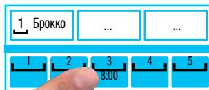
Нажмите на кнопку уровня загрузки и удерживайте её нажатой до тех пор, пока на дисплее не отобразится «0:00»
