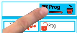
Подтвердите ввод – нажмите кнопку «Удалить» и удерживайте её нажатой. Процесс удаления отображается на дисплее в виде перемещающейся стрелки
