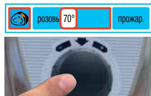
Введённые настройки автоматически сохраняются через 4 секунды или при нажатии (функция «Push») на центральный регулятор.
