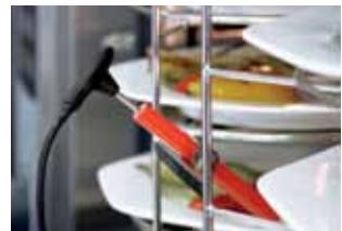
В режиме Finishing® «Банкет / тарелки» вставляйте термозонд в керамическую трубку на тележек-кассете для тарелок.
