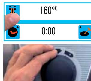
Нажмите кнопку настройки температуры и установите температуру в рабочей камере
