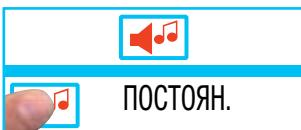
Нажмите кнопку и установите длительность звукового сигнала с помощью центрального регулятора
