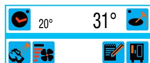
Установите параметры приготовления (например, температуру в рабочей камере, температуру внутри продукта и т.д.)
