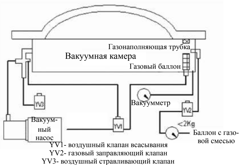
Схема вакуумного упаковщика с системой газации
