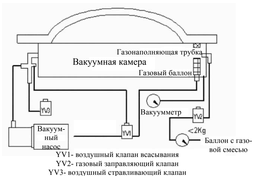
Схема вакуумного упаковщика с системой газации
